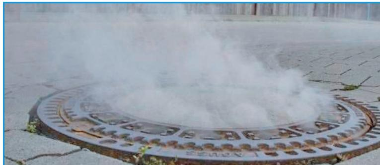
Hierfür wird ein Abschnitt des Kanals (Regen- oder Schmutzwasser) zwischen zwei Schächten (ca. 150 m) kurzfristig abgesperrt und mit einem geruchlosen, umwelt- und gesundheitsverträglichen Signalnebel gefüllt. Tritt bei der Untersuchung der Schmutzwasserleitung Nebel an Dachrinnen oder Hofeinläufen aus, liegt augenscheinlich ein Fehlan schluss vor.
