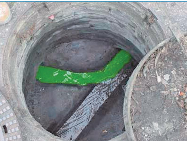
Hierfür wird in die Schmutzwasserabflüsse im Haus der nicht umweltgefährdende Farbstoff Uranin gegeben. Tritt gefärbtes Wasser in den Regenwasserabfluss ein, sind die Anschlüsse falsch verbunden worden. Der Farbstest kann auch umgekehrt zur Überprüfung von Fehlan schlüssen von Regenwasserleitungen an Schmutzwasserleitungen erfolgen.
